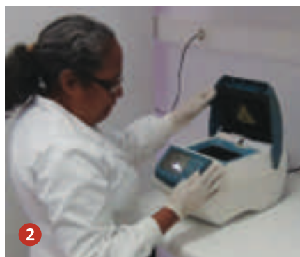
1) Colocar os tubos de PCR no aparelho de PCR; 2) fechar o aparelho; 3) programar o aparelho para fazer vários ciclos de variação de temperatura
