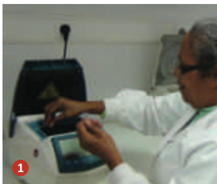
1) Colocar os tubos de PCR no aparelho de PCR; 2) fechar o aparelho; 3) programar o aparelho para fazer vários ciclos de variação de temperatura
