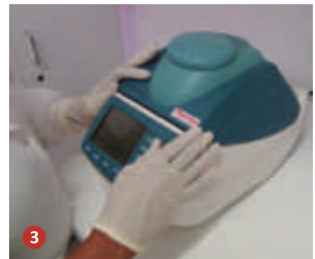
1) Colocar os tubos de PCR no aparelho de PCR; 2) fechar o aparelho; 3) programar o aparelho para fazer vários ciclos de variação de temperatura
